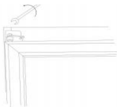
8. Utáhněte čep horního pantu.
