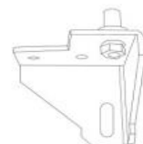
9. Vyjměte čep spodního pantu a otočte spodní pant o 90 stupňů.
