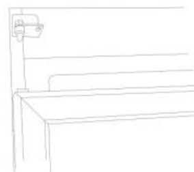
6. Vložte čep pantu na opačnou stranu, neutahujte jej.
